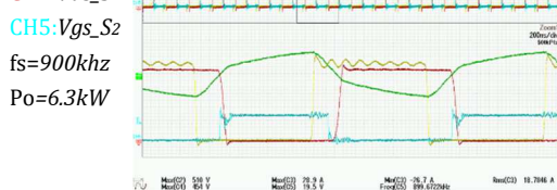
Fig. 19. Discharging mode (460VHVO-420VBus)
