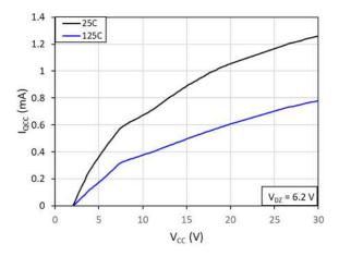
Fig. 13.  $\rm V_{\rm CC}$  quiescent current ( $\rm I_{\rm QCC})$  vs. supply voltage (V<sub>CC</sub>)
