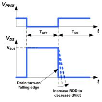
Fig. 25. Turn-on dv/dt slew rate control
